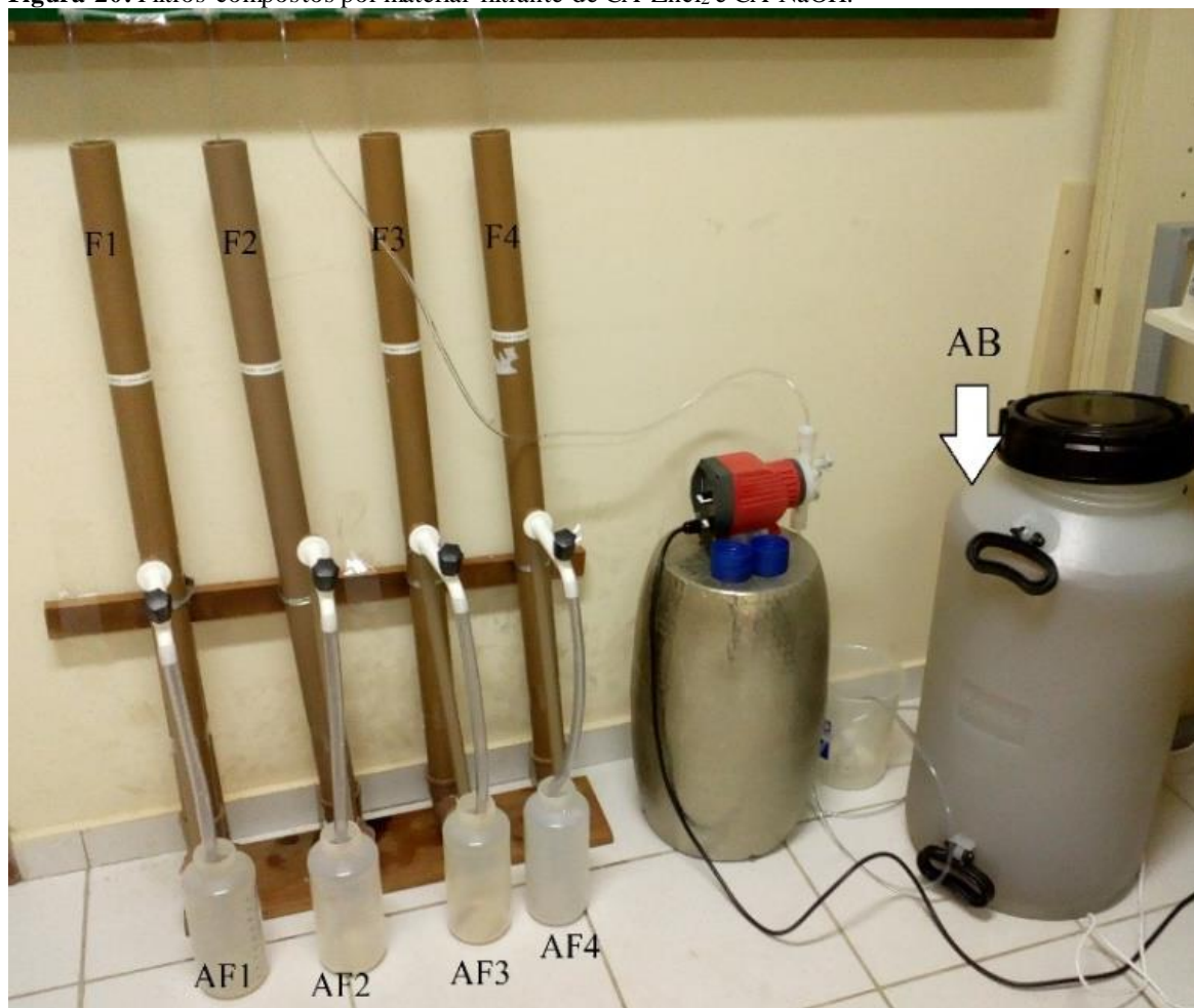
Figura 20: Filtros compostos por material filtrante de CA ZnCl_2 e CA NaOH.
