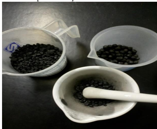
Figura 15: trituração dos carvões ativados por maceração.
